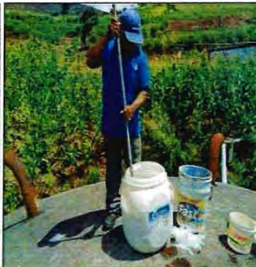
FOTO 60: Proceso de disolución de cloro en un recipiente (generalmente se realiza en un balde de 20 lt). En este proceso, se tapa el recipiente y se deja reposar por un lapso de tiempo de 20 a 30 minutos, antes de realizar el vertimiento de al reservorio o tanque de cloración.
